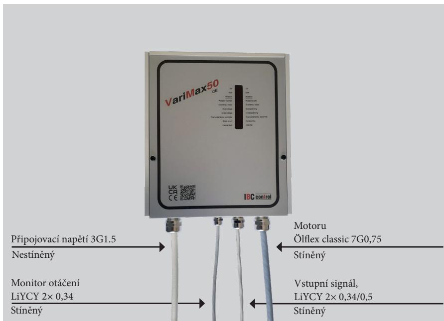
Pro stíněné kabely je nutné použít kabelové průchodky EMC.
