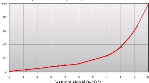
Vstupní signál je přímo úměrný účinnosti rotoru, což značí, že vstupní signál a otáčky jsou podle přiloženého diagramu.
