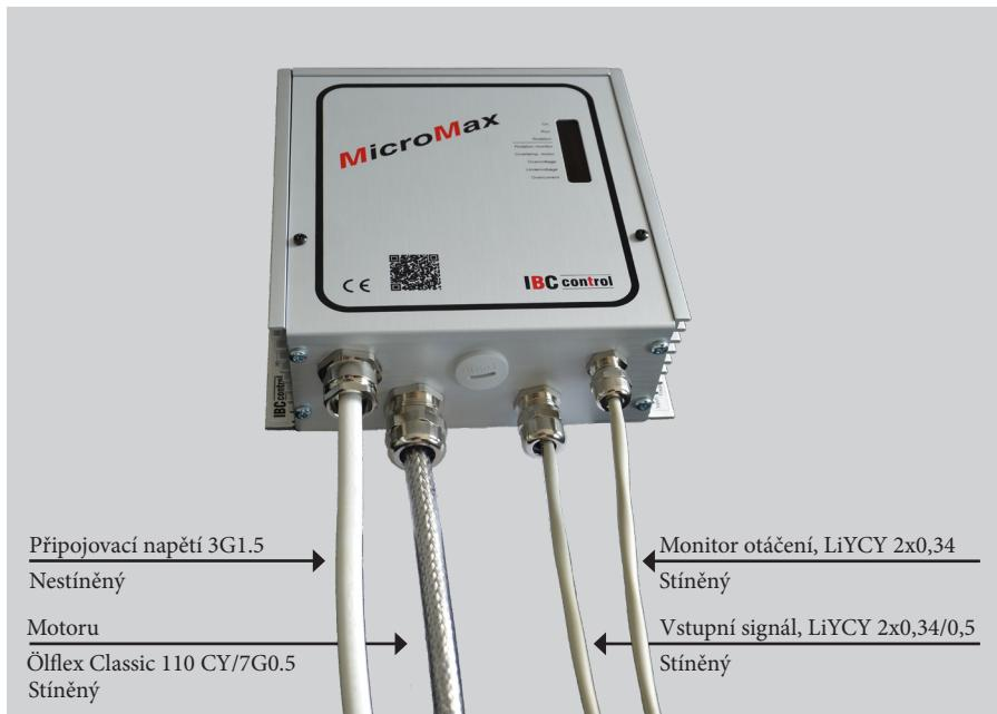
Pro stíněné kabely je nutné použít kabelové průchodky EMC.
